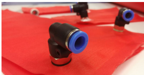
Abbildung 32: Kraftschlüssige Variante mit gewinkelten Steckanschlüssen (links) und Parameter für die kraftschlüssigen Varianten (rechts)
