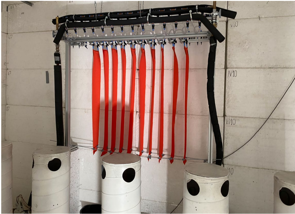
Abbildung 34: Aufbau der Funktionsmuster in einer Klimakammer zur Leistungsmessung
