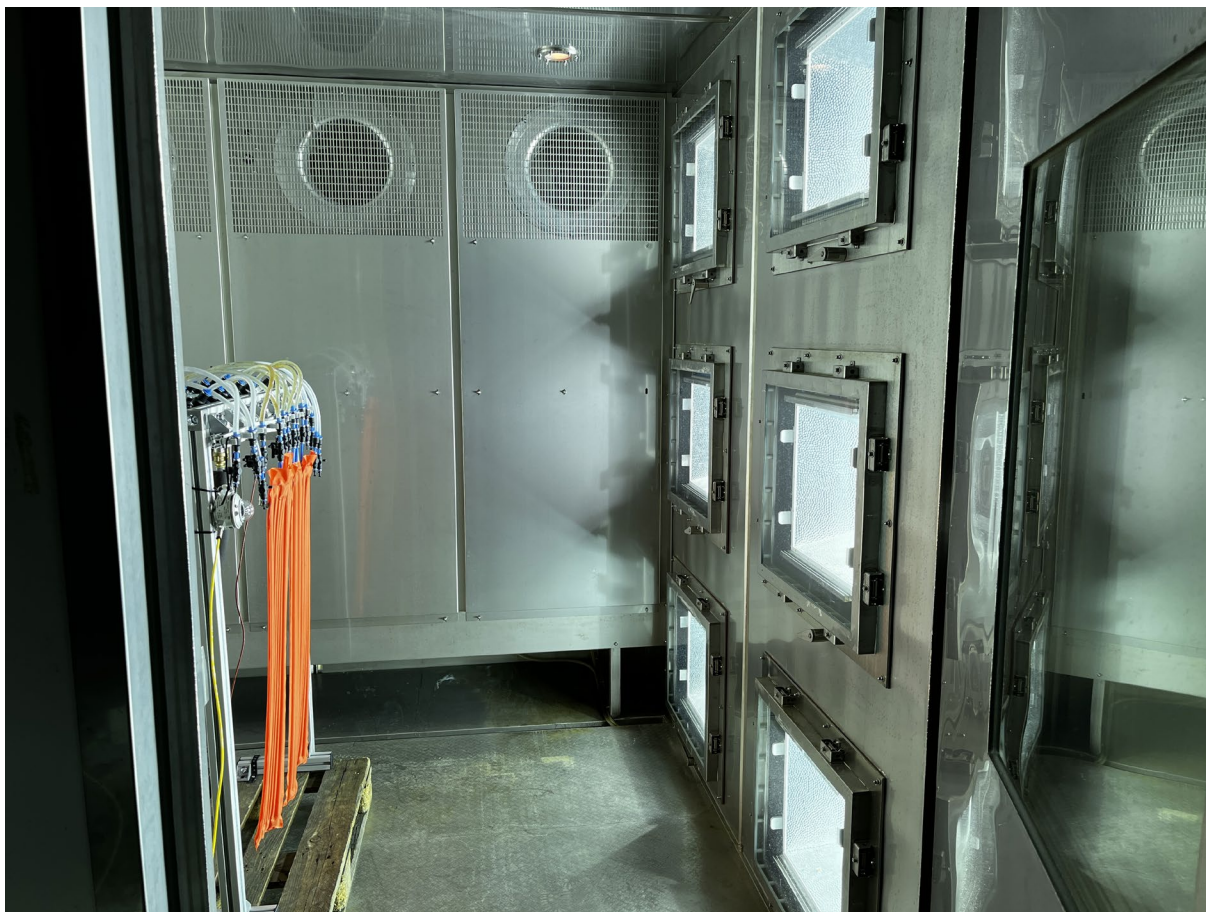
Abbildung 42: Ansicht Sonnensimulator mit eingebrachtem Demonstrator zur Ermittlung der Kühlleistung bei solarer Einstrahlung
