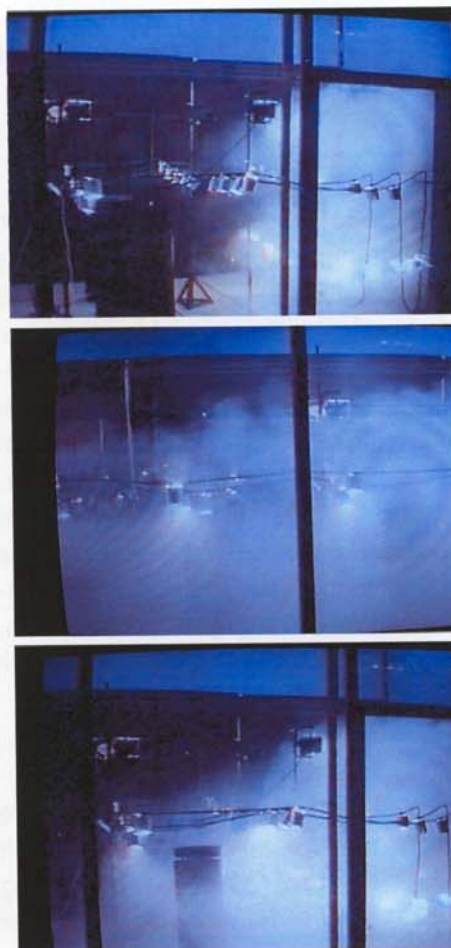
Bild 2: Zuluft aus Luftdurchlass mit Nebel markiert
