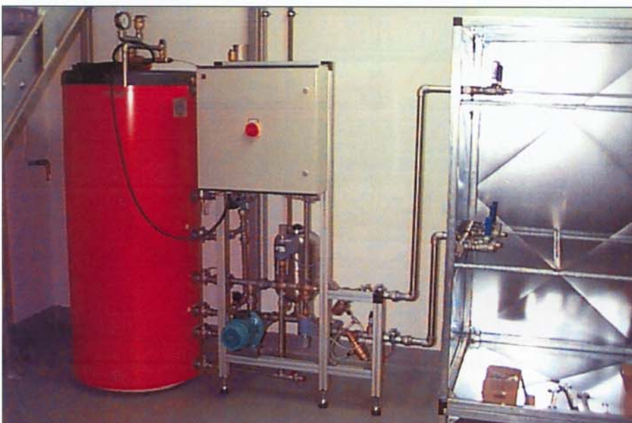
Bild 1: Prüfstand für Kunststoffrohre und Verbinder nach DVGW und DIN
