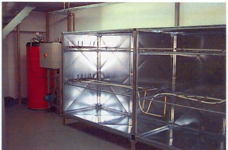
Bild 4: Anordnung der Prüflinge in gekapselter Versuchskammer
