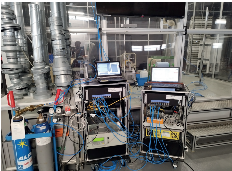
Bild 3: Spurengas-Messaufbau im Raumluftströmungslabor
