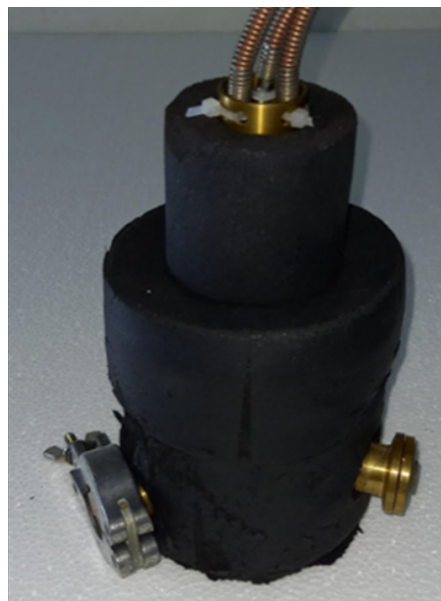
Bild 1: Aktueller Messkopf mit Dämmung und Messfühlern
