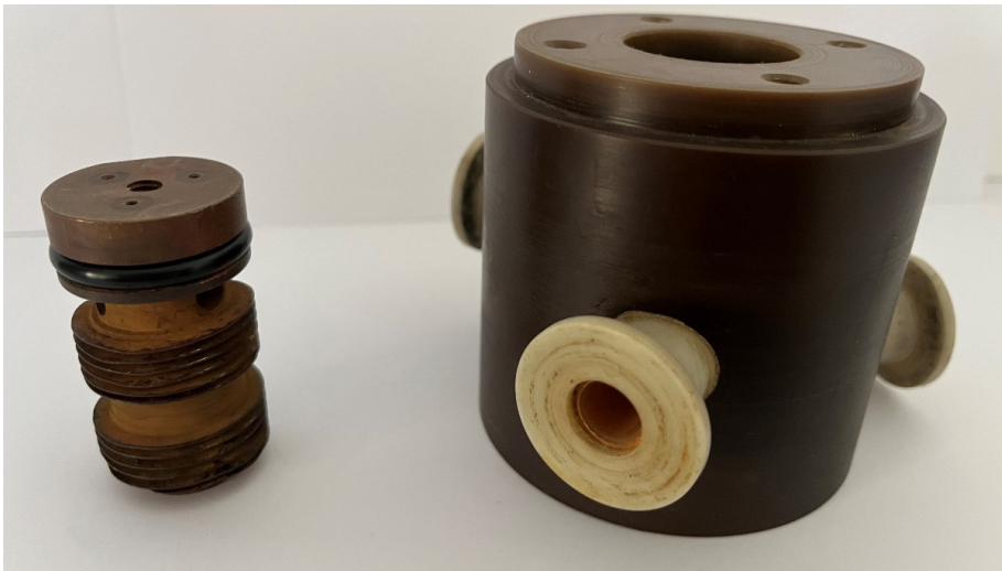
Bild 2: Messkopf zerlegt ohne Dämmung und Messfühler
